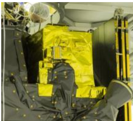
Лётный экземпляр комплекса АЦС на борту аппарата TGO, покрытый экранно-вакуумной теплоизоляцией (с) Роскосмос/ЕКА/ЭкзоМарс/АЦС/ИКИ
